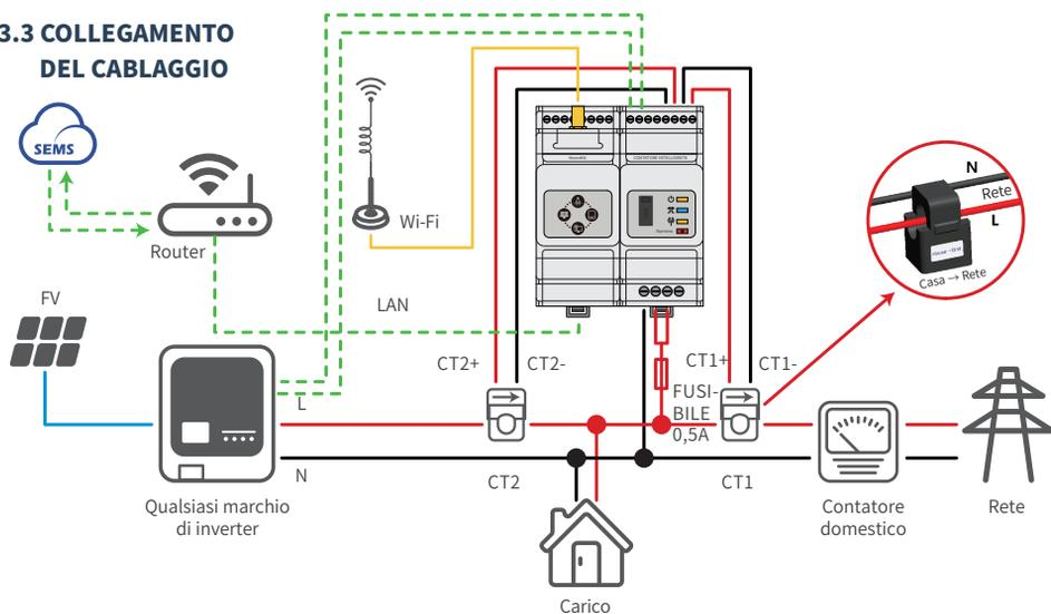
\* Si prega di notare la posizione del CT: CT1 è collegato al punto di rete, mentre CT2 è collegato al punto di uscita dell'inverter e la direzione della freccia sul CT è rivolta verso la rete dal lato dell'inverter. I fili di collegamento di CT sono ROSSI in corrispondenza di '+' e NERI in corrispondenza di '-'.
