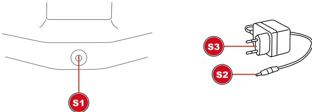
S1 Anschlussbuchse für DC-Hohlstecker
