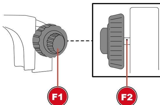
Abb. 2: Friktionseinstellung am Fokusrad (modellabhängig links oder rechts).
