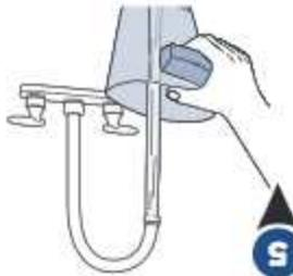
Retirer le filtre du réservoir de récupération d'eau sale des débris.
