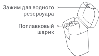
Резервуар для грязной воды
