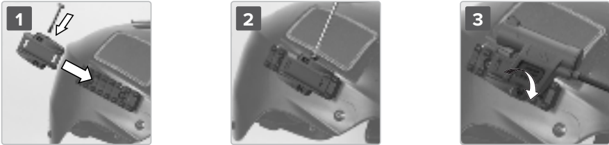
Figura 9 – Montaje sobre riel (ABR)
