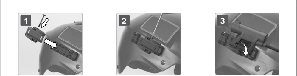
Abbildung 9 – (ABR) Above Rail-Befestigung
