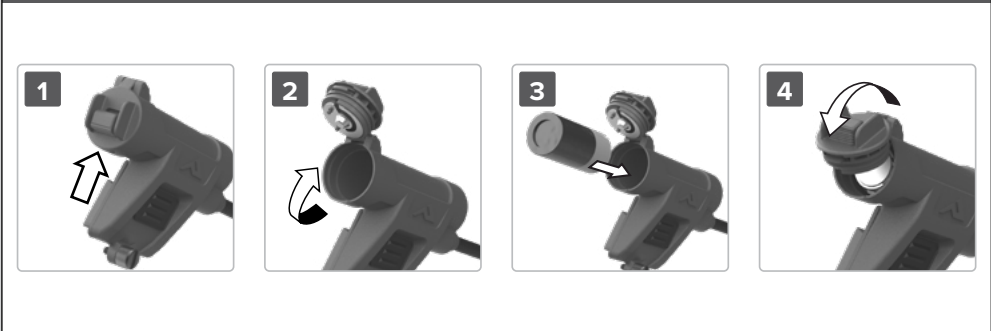
Abbildung 1 – Einlegen der Batterien
