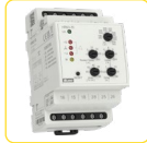
HRN3-70 - Funkce: výpadek/pořadí/ asymetrie fází, nast. podpětí a pevné přepětí + nast. paměť - Rozsah: 3x 190-500V (nastavitelný) - Výstup: 2x přep. 16A Napájení z hlídáního napětí (L1, L2, L3). TRUE RMS. str. 106
