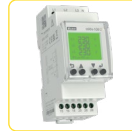
HRN-100/2 - Funkce: volitelně výpadek/ pořadí/asymetrie fází, nast. podpětí i přepětí. + nadfrek. a podfrek. - Rozsah: 3x 90-500V - Výstup: 2x přep. 5A 3/4 vodičové zapojení. Napájení z hlídáního napětí (L1, L2, L3, N volitelně). str. 110
