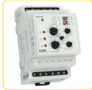
HRN-43N Jako HRN-43, ale hlídá i přerušení nul. vodiče. - Rozsah: 3x 48-276V Nast. zpoždění, hystereze, paměť a asymetrie fází (i pro HRN-43). str. 104
