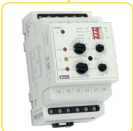
COS-2 - Funkce: hlídá spodní a horní úroveň - Rozsah: 3x 84-480V (1/3-F zapojení) - Výstup: 2x přep. 16A - Napájení: AC/DC 24V; AC 110; 230; 400V (galv. odděleno) Vyhodnocuje fázový posun mezi proudem a napětím (cos φ). str. 114
