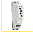
HRN-36; HRN-36/2 - Funkcí: 9 - Rozsah: DC 6-30V - Výstup: 1x; 2x přep. 16A Napájení z hlídáního napětí. str. 94
