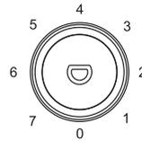
Stel de temperatuur in met de thermostaatknop en kies een stand tussen 1 en 7. Wij adviseren u het apparaat in te stellen op de stand 3-4. Het apparaat zal nu continue koelen tot de ingestelde temperatuur is bereikt. Laat het apparaat op temperatuur komen voordat u het met levensmiddelen vult. Dit duurt meestal 2 tot 3 uur. Daarna kunt u de thermostaat op de gewenste stand zetten en het apparaat vullen met levensmiddelen.
