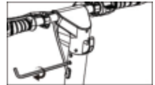
3. قم بتوصيل المقود بمسند السكوتر الإلكتروني ونيوم بقله باستخدام المفتاح.
