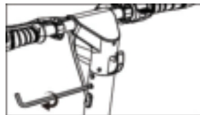
3. 将车把安装到电动滑板车的支架上，并用钥匙锁上。
