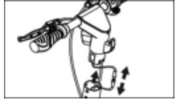
2. Deconectați volanul, Deconectați cablul Afișaj - controler.
