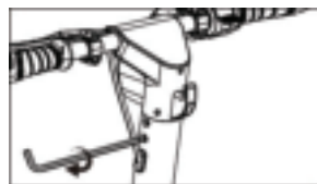
3. Przymocuj kierownicę do podstawy hulajnogi elektrycznej i zablokuj ją kluczem.
