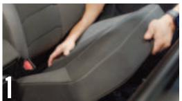
PULL UP ON THE REAR DRIVER SIDE SEAT TO REMOVE THE BOTTOM HALF
