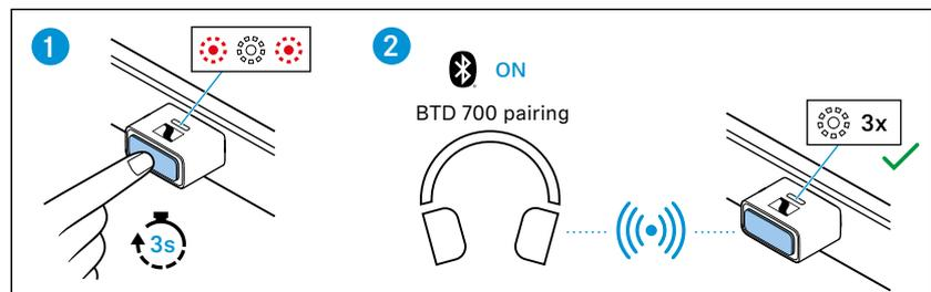
После установления сопряжения светодиодный индикатор состояния мигает белым 3 раза.
