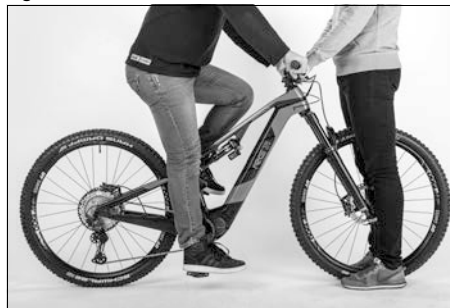
Fig. 39: Determinar la altura del sillín correcta
