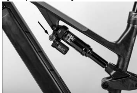
Fig. 52: Ajuste de la amortiguación
