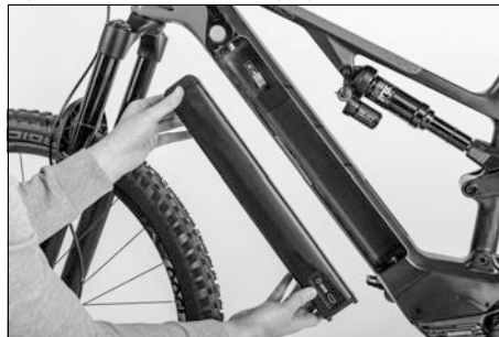
Fig. 27: Extraer la batería de propulsión
