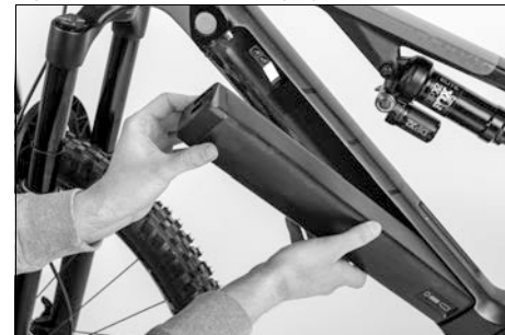
Fig. 28: Montar la batería de propulsión
