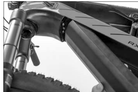
Fig. 33: Montar la batería de propulsión
