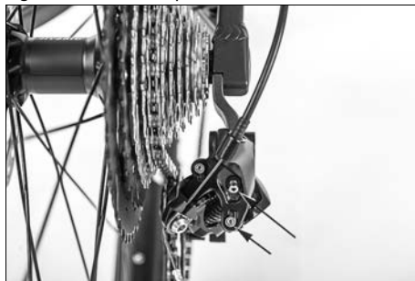
Fig. 26: Tornillos de tope final
