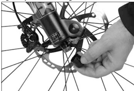
Fig. 49: Ajuste de la amortiguación
