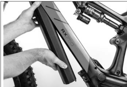
Fig. 32: Extraer la batería de propulsión
