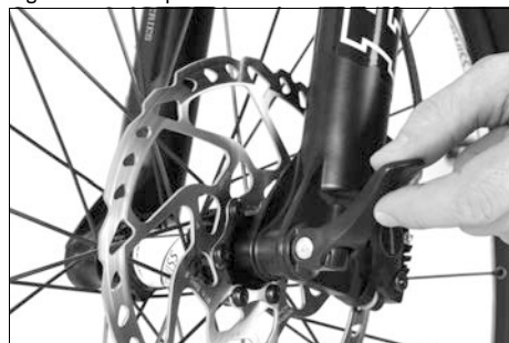
Fig. 54: Montar la unión roscada del eje / rueda
