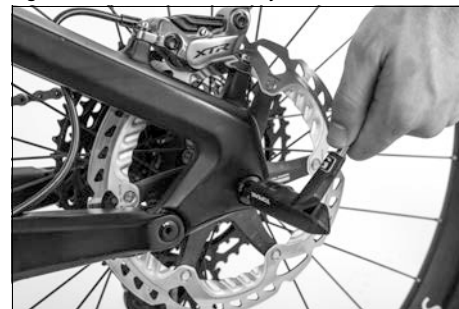
Fig. 57: Montar el sistema de eje de la rueda trasera
