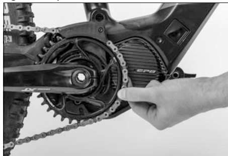
Fig. 23: Comprobar el estado de la cadena
