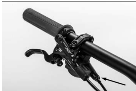
Fig. 26: Tornillos de tope final
