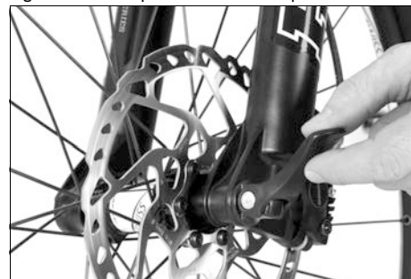
Fig. 56: Cerrar la palanca de cierre rápido
