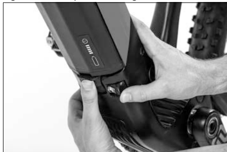
Fig. 31: Soltar el pasador de seguridad
