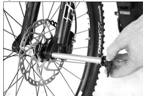
Fig. 55: Montar el sistema de eje de la rueda delantera
