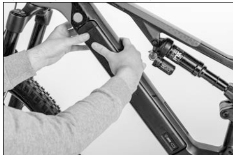
Fig. 29: Asegurar la batería de propulsión
