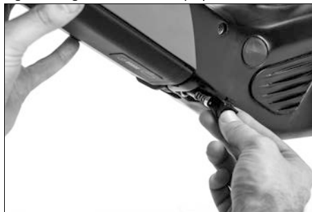
Fig. 30: Asegurar la batería de propulsión
