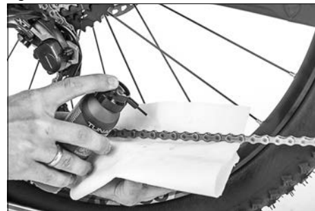
Fig. 22: Lubricar la cadena
