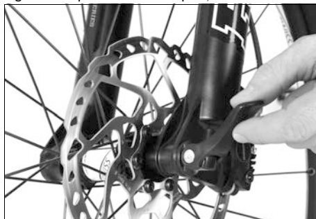
Fig. 12: Comprobar el cierre rápido, rueda delantera
