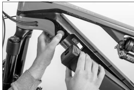
Fig. 26: Accionar el mecanismo de extracción
