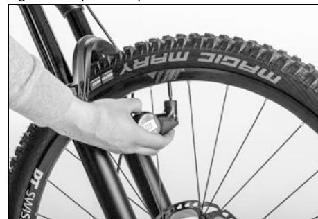
Fig. 13: Comprobar la presión de los neumáticos
