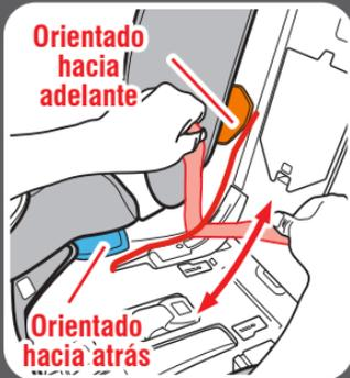
**5. Tire de los conectores del anclaje inferior hasta sacarlos de las aberturas que están en la vía del cinturón**
