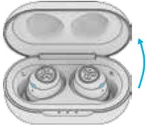
3 Toque rápidamente tres veces cada sensor táctil de los auriculares. Ambos parpadearán en azul y seguidamente se apagarán. Una vez desconectados, cierre la carcasa de carga.
