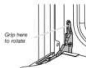
A. Traba de bisagra de la puerta del horno en posición trabada
