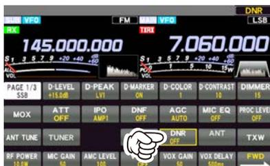
3. Ruotare la manopola [FUNC] per regolare il livello DNR. L'indicatore "DNR" si illumina sul display.
