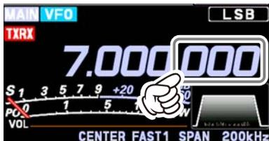
2. Inserire la frequenza mediante i tasti numerici.
