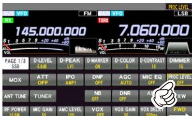
4. Sforare l'area dello strumento sul display per selezionare lo strumento "COMP".
