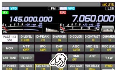
3. Attivare la trasmissione e parlare nel microfono regolando il livello AMC con la manopola [FUNC].
