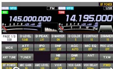
3. Ruotare la manopola [FUNC] per regolare la potenza d'uscita RF.
