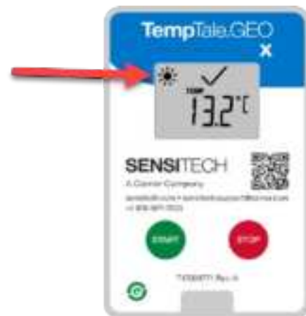
Monitor włączony, gdy miga ikona słońca.
