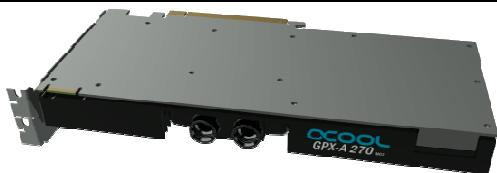
**Montieren** Sie nun den zusammen gebauten Kühler auf die Grafikkarte wie im Bild zu sehen. Falls eine Schutzfolie auf dem Kühlertor vorhanden ist, entfernen Sie bitte jetzt die Schutzfolie. Reinigen Sie die Kontaktflächen auf der Bodenseite des Kühlers mit Spritus oder ähnlichem Mitteln. Die Fläche muss frei von Verunreinigungen sein.
