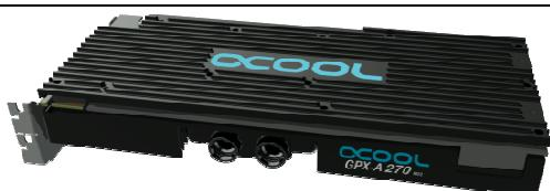
**Legen** Sie Backplate wie in dem Bild gezeigt auf die Grafikkarte. Ein leichter Druck sorgt für optimalen Kontakt zwischen Backplate, Kühler und Grafikkarte.
