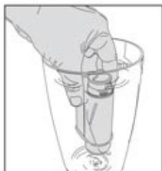
Retirer le filtre à eau INTENZA+ de l'eau, le régler d'après la dureté de l'eau mesurée (voir le chapitre « Mesure de la dureté de l'eau ») et sélectionner à la base du filtre :
