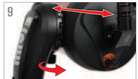
Pour régler l'équilibre ou retirer le tube de la base, desserrez simplement le bouton de serrage rapide et faites glisser le tube vers la cellule arrière du tube. Tenez le tube fermement lorsque vous le montez ou le démontez et assurez-vous que la pince de la queue d'aronde est serrée avant de lâcher le tube.
