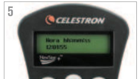
5 Use el teclado numérico para introducir la información de hora. Pulse ENTER para continuar. Pulse DESHACER para retroceder. Si se introduce en formato de 12 horas deberá seleccionar AM o PM. No es necesario si se introduce en formato de 24 horas.
