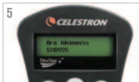
5 Utilizzare il tastierino numerico per immettere le informazioni relative all'ora. Premere ENTER (INVIO) per continuare. Premere UNDO (INDIETRO) per tornare indietro. Se viene inserito il formato da 12 ore, occorre selezionare AM o PM. Ciò non occorre se è inserito il formato da 24 ore.
