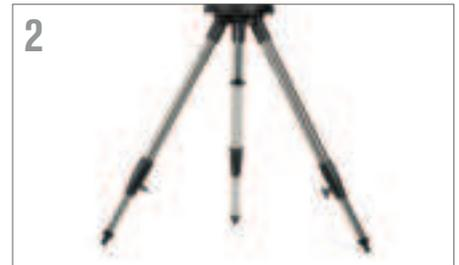
Montare il treppiede allargando completamente le gambe verso l'esterno e sistemare il treppiede sul pavimento.
