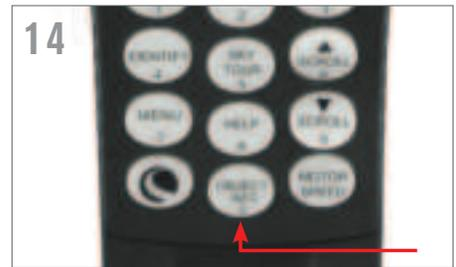
Appuyez sur INFOS OBJET (numéro 0 du clavier) pour lire les informations sur l'objet. Appuyez sur le bouton DÉFILEMENT vers le BAS pour afficher l'objet suivant de la liste. Appuyez sur ENTRER pour automatiquement orienter le télescope sur la cible sélectionnée.
