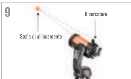
9 Se il cercatore è stato correttamente allineato, la stella di allineamento dovrebbe ora essere visibile all'interno del campo visivo dell'oculare.
