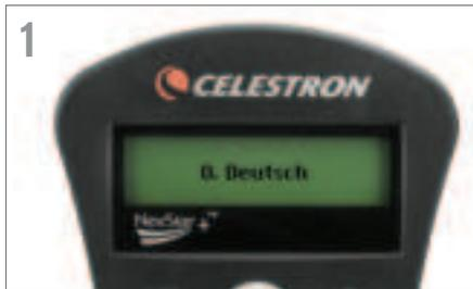
1 Wenn Sie das Teleskop zum ersten Mal einschalten, müssen Sie die angezeigte Sprache auswählen. Drücken Sie die Zifferntaste, die der von Ihnen bevorzugten Sprache entspricht und drücken Sie ENTER (Eingabe).
