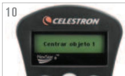
10 El mando manual le solicitará que centre el objeto brillante en el ocular. Los motores se ralentizarán automáticamente para ayudarle con ajustes precisos. Cuando el objeto esté centrado, pulse ALINEAR para aceptarlo como primer punto de alineación.
