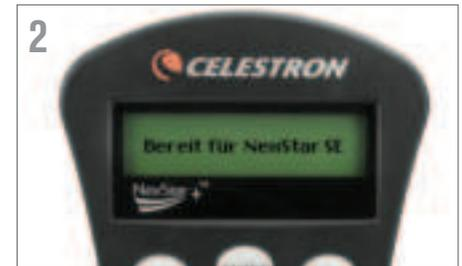
2 Auf dem Display wird „NexStar SE Ready“ (NexStar SE Bereit) angezeigt. Drücken Sie ENTER (EINGABE), um den Ausrichtungsvorgang zu starten.
