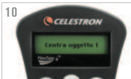
10 Il telecomando vi chiederà ora di centrare l'oggetto luminoso nell'oculare. I motori rallenteranno automaticamente per facilitare le regolazioni di precisione. Una volta centrato l'oggetto, premere ALIGN (ALLINEA) per accettarlo come primo punto di allineamento.
