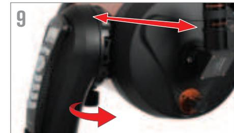
Um den Tubus zu justieren oder von dem Sockel zu entfernen, lösen Sie einfach den Schnellspann-Klemmknopf und schieben Sie den Tubus zurück in Richtung der hinteren Zelle des Tubus. Halten Sie den Tubus bei der Montage oder Demontage fest und vergewissern Sie sich, dass die Schwalbenschwanzklemme fest sitzt, bevor Sie den Tubus loslassen.
