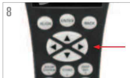
8 La montatura è ora pronta per l'allineamento. Da questo momento in poi, non muovere il telescopio manualmente: utilizzare solo i pulsanti direzionali di puntamento sulla pulsantiera.
