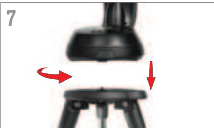
Setzen Sie den Sockel des Teleskops auf den Stativkopf, sodass das Loch in der Mitte des Montagesockels mit dem Positionierstift oben auf dem Stativ ausgerichtet ist. Drehen Sie die Teleskopmontierung so, dass die 3 GummifüÙe mit den 3 Aussparungen auf der Stativ-Montageplatte ausgerichtet sind.
