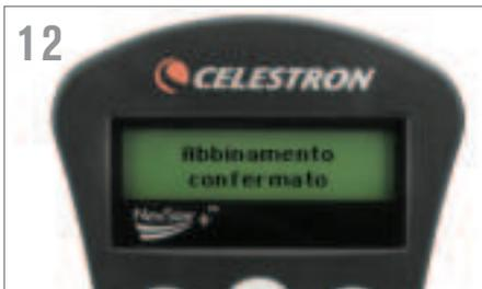
Ripetere la procedura per la terza stella di allineamento. Una volta allineato il telescopio all'ultima stella, sul display viene visualizzata la dicitura "Match Confirmed" (Abbinamento confermato). Premere UNDO (INDIETRO) per mostrare i nomi degli oggetti luminosi allineati, oppure premere ENTER (INVIO) per accettare i tre oggetti per l'allineamento.
