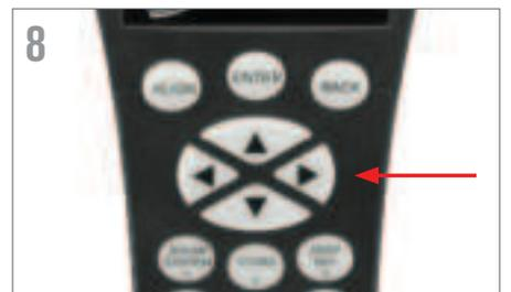
8 El soporte está listo para alinearlo. A partir de este momento, no mueva el telescopio con la mano - use solamente los botones direccionales del mando manual.
