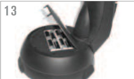
13 Entfernen Sie die Batterieabdeckung von der Mitte des Sockels, indem Sie den runden Teil der Abdeckung vorsichtig anheben. Legen Sie 8 AA-Batterien in das Batteriefach ein und bringen Sie die Batteriefachabdeckung wieder an. Achten Sie beim Einlegen der Batterien auf die richtige Polarität.
