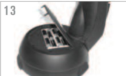
Retirez le couvercle de la batterie du centre de la base en soulevant doucement la partie ronde du couvercle. Insérez 8 piles AA dans le support et remettez le couvercle des piles. Veillez à insérer les piles dans le respect des polarités.
