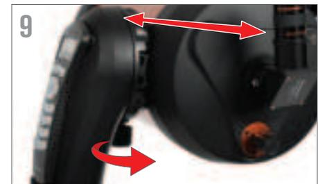
Per regolare l'equilibrio o rimuovere il tubo dalla base, allentare semplicemente la manopola del fermo a rilascio rapido e fare scorrere il tubo indietro verso la cella posteriore del tubo. Tenere saldamente il tubo durante il montaggio e lo smontaggio e assicurarsi che il fermo a coda di rondine sia serrato prima di lasciare andare il tubo.
