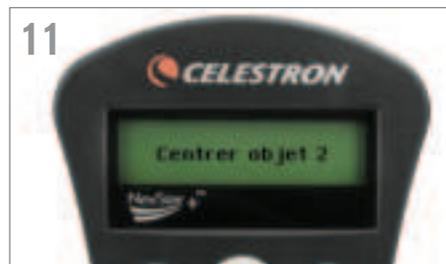
11 Pour le second objet d'alignement, choisissez une étoile brillante ou une planète aussi éloignée que possible du premier objet d'alignement. Utilisez les flèches directionnelles pour le centrer dans le chercheur, puis appuyez sur ENTRÉE. Les moteurs ralentissent. Centrez-le dans l'oculaire et appuyez sur ALIGNER.
