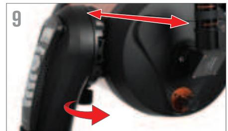
Para ajustar el equilibrio o sacar el tubo de la base, afloje el mando de la fijación de liberación rápida y deslice el tubo hacia la célula posterior de éste. Aguante firmemente el tubo al montar o desmontar y asegúrese de que la fijación machihembrada esté apretada antes de soltar el tubo.
