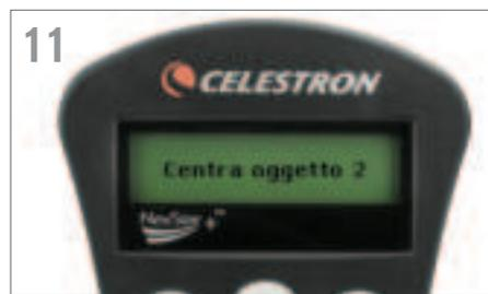
11 Per il secondo oggetto di allineamento, scegli una stella o un pianeta luminoso il più lontano possibile dal primo. Utilizza i tasti freccia direzionali per centrarlo nel cercatore e premi ENTER (INVIO). I motori rallenteranno. Centralo nell'oculare e premi ALIGN (ALLINEA).
