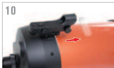
Schieben Sie das StarPointer-Sucherfernrohr auf die Montagehalterung und ziehen Sie die Schrauben an der Seite des StarPointer-Sucherfernrohrs fest, um es zu fixieren. Ziehen Sie den kleinen Kunststoff-Abstandshalter unter der Batterieabdeckung heraus, damit die Batterie Kontakt herstellen kann.
