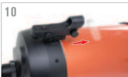
Faites glisser le chercheur à point-rouge StarPointer sur le support de montage et serrez les vis situées sur le côté du chercheur StarPointer pour le fixer en place. Tirez sur la petite languette en plastique sous le couvercle de la batterie pour permettre à la batterie d'entrer en contact.
