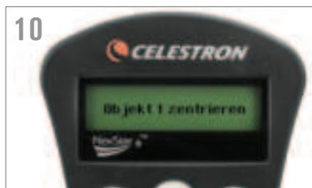
10 Die Handsteuerung fordert Sie nun auf, das helle Objekt im Okular zu zentrieren. Die Motoren werden automatisch langsamer, um feine Anpassungen zu erleichtern. Sobald das Objekt zentriert ist, drücken Sie AUSRICHTEN, um es als Ihren ersten Ausrichtungspunkt zu übernehmen.
