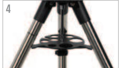
Deslice la bandeja de accesorios sobre la vara estriada de forma que cada brazo de la bandeja se apoye en cada pata del trípode. Vuelva a colocar y apriete el mando de bloqueo de la abrazadera de la pata para asegurar con firmeza la bandeja en posición.
