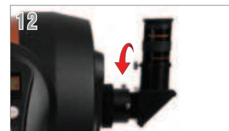
Setzen Sie die verchromte Steckhülse des 25-mm-Okulars in den Star-Zenit Spiegel ein und ziehen Sie die verchromte Schraube zum Sichern fest.
