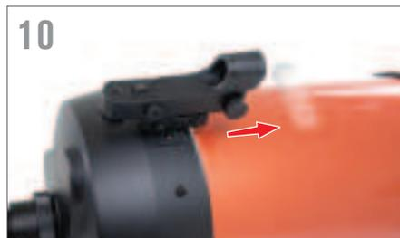
Deslice el localizador de punto rojo StarPointer en el soporte de montaje y apriete los tornillos ubicados en el lateral del localizador StarPointer para asegurarlo en posición. Tire de la pequeña pestaña de plástico bajo la cubierta de la batería para permitir que la batería haga contacto.
