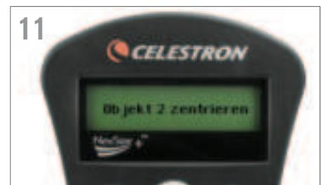
11 Für das zweite Ausrichtungsobjekt wählen Sie einen hellen Stern oder Planeten, der so weit wie möglich vom ersten entfernt ist. Verwenden Sie die Richtungs-Pfeiltasten, um es im Sucherfernrohr zu zentrieren, drücken Sie dann EINGABE. Die Motoren werden langsamer. Zentrieren Sie es im Okular und drücken Sie AUSRICHTEN.
