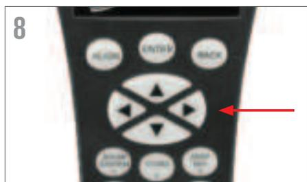
8 La monture est maintenant prête à être alignée. À partir de maintenant, ne déplacez plus le télescope manuellement ; utilisez uniquement les boutons de direction de la télécommande. Utilisez les boutons pour déplacer le télescope vers un objet céleste brillant. Vous n'avez pas besoin de connaître le nom ou le type de l'objet (étoile, planète, etc.). Une fois centré dans le chercheur, appuyez sur ENTRÉE.
