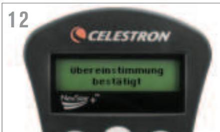
Wiederholen Sie den Vorgang für den dritten Ausrichtungsstern. Wenn das Teleskop auf den letzten Stern ausgerichtet wurde, wird auf dem Display „Match Confirmed“ (Übereinstimmung bestätigt) angezeigt. Drücken Sie die Taste UNDO (ZURÜCK), um die Namen der drei hellen Ausrichtungsobjekte anzuzeigen oder drücken Sie ENTER (EINGABE), um diese drei Objekte zum Ausrichten anzunehmen.
