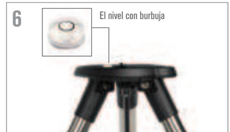
Ponga el nivel con burbuja sobre el trípode y ajuste cuidadosamente las patas hasta que el cabezal del trípode esté nivelado. Saque el nivel con burbuja cuando haya terminado.
