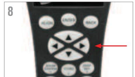
8 Die Montierung ist nun bereit für die Ausrichtung. Von diesem Punkt an bewegen Sie das Teleskop nicht mehr von Hand – verwenden Sie nur die Richtungs-Tasten der Handsteuerung.
