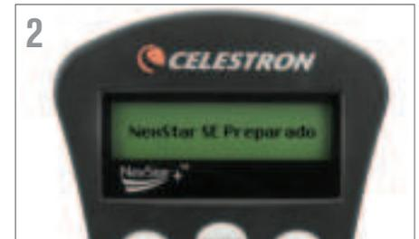
2 La pantalla mostrará "NexStar SE preparado". Pulse ENTER para iniciar el procedimiento de alineación.
