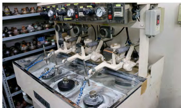
ナック横浜工場にあるレンズ研磨機
