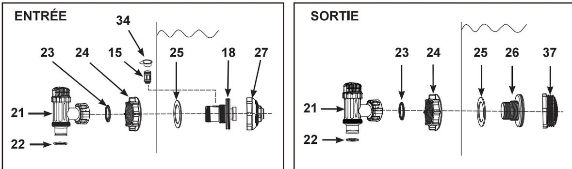
Si la pompe a été achetée en tant qu'élément d'un ensemble piscine des tuyaux / connexions de 32mm, les pièces d'assemblage ci-dessous sont incluses :
