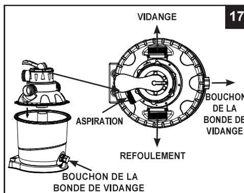
**IMPORTANT** : Il y a trois ports de connexions prévus pour les tuyaux sur la vanne 6 voies, assurez vous que le port de refoulement (de la cuve à la piscine) soit face à la piscine (voir dessin 18).
