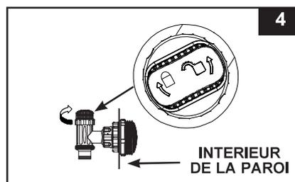
**INSTRUCTIONS D'INSTALLATION DE LA BUSE ORIENTABLE ET DES VANNES D'ARRÊT (optionnel)**
