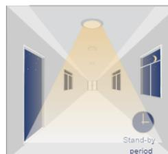
Nach Ablauf der Haltezeit wird das Licht auf den Standby-Dimmwert gesetzt. Wenn die Standby-Zeit auf 0 sek. eingestellt wurde, schaltet der Sensor das Licht sofort nach der Haltezeit aus.
