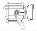
4.2按住卡口推制, 逆时针旋转即可取下灯头反 光罩。
