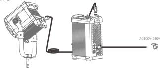
注: 严禁通电时插拔电源线或连接线, 以免造成意外
