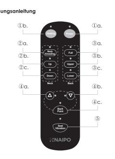
a. Power-Taste: Einmal Drücken, um das Gerät einzuschalten, die Anzeigelampe bleibt an; Nochmals drücken, die Anzeigelampe blinkt und das Gerät wird zurückgesetzt. Das Licht erlischt nach der Zurückstellung und das Gerät schaltet
