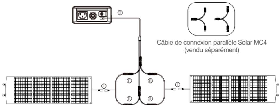
Câble de connexion parallèle Solar MC4
