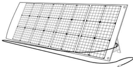
2. Élevez le panneau solaire au-dessus du sol en utilisant les béquilles. Cela aidera à s'adapter à l'angle optimal face au soleil et à éviter la surchauffe en augmentant le débit d'air.
