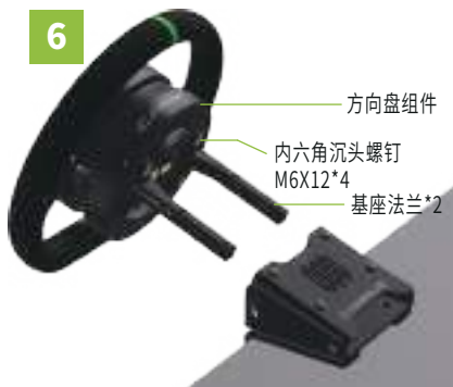
图6：将方向盘整体通过4颗M6X12内六角沉头螺钉与基座法兰进行紧固连接在一起；
