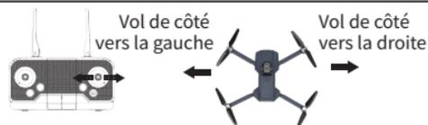
Lorsque le levier droit est poussé vers la droite, le fuselage du drone vole vers la droite. Poussez vers la gauche, le fuselage du drone vole vers la gauche.
