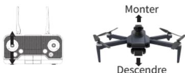
Lorsque le levier gauche (accélérateur) est poussé vers le haut, la vitesse de l'hélice augmente et le drone monte. Poussez vers le bas, la vitesse de l'hélice ralentit et le drone descend.
