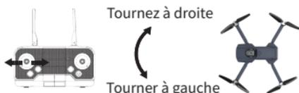
Lorsque le levier gauche est poussé vers la gauche, la tête du drone tourne vers la gauche. Poussez vers la droite, la tête du drone tourne vers la droite.
