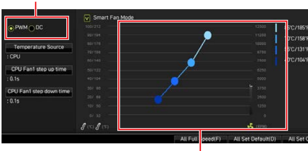
風扇速度的漸變點，允許您根據 CPU 溫度調整風扇速度。
