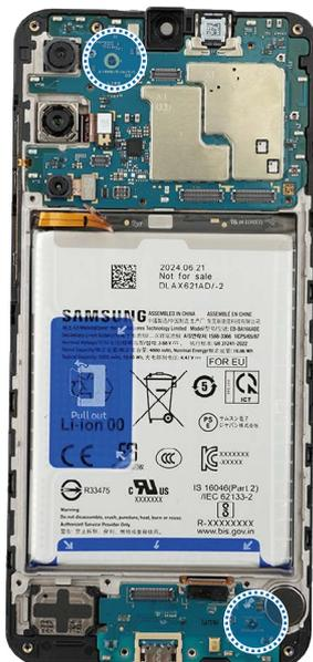
11 Utilice los dedos o las pinzas para colocar la cámara frontal en el orificio de la cámara de forma que la lente esté orientada hacia delante, e inserte con suavidad la cámara frontal. Conecte con cuidado el conector de la cámara en la placa principal.
