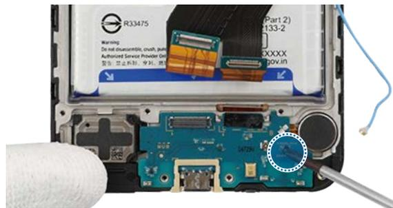
6 Utilice los dedos para presionar suavemente el conector del módulo de pantalla sobre la cinta adhesiva del puerto de carga y fíjelo.
