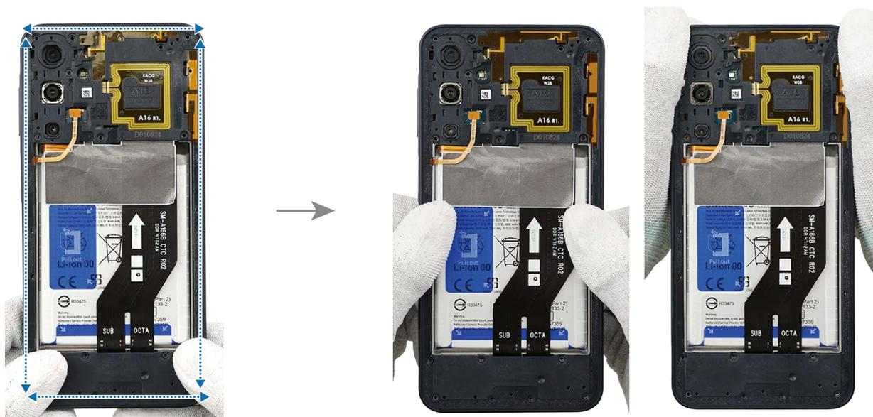
3 Conecte el conector del sensor de reconocimiento de huellas digitales a la placa principal.
