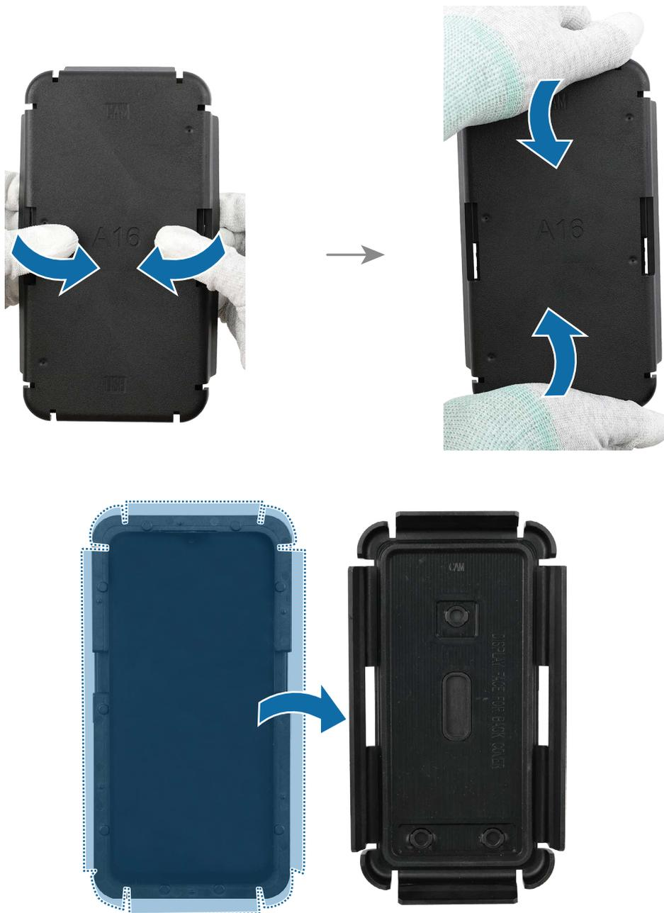
10 Desconecte el módulo de pantalla de la bandeja de presión inferior.
