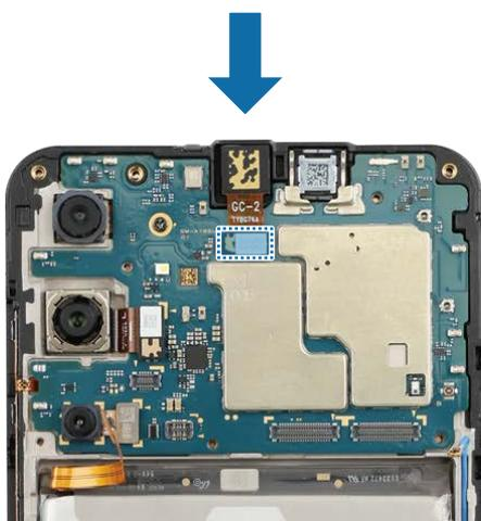
14 Coloque el cable flexible en el chasis del dispositivo y conecte los 4 conectores con cuidado.
