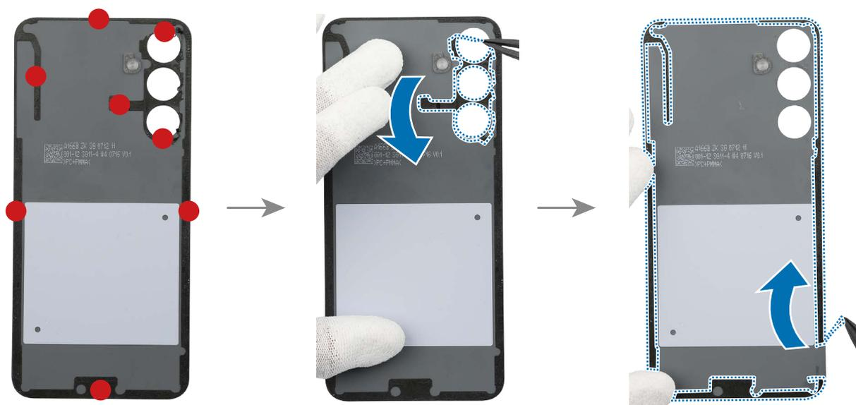
2 Utilice los dedos para insertar con cuidado la carcasa de cámaras desde el lado derecho y montarla. Presione la carcasa de cámaras suavemente con los dedos para que quede bien montada.
