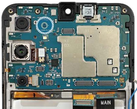
4 Utilice los dedos o las pinzas para colocar la cámara frontal en el orificio de la cámara de forma que la lente esté orientada hacia delante, e inserte con suavidad la cámara frontal. Conecte con cuidado el conector de la cámara en la placa principal.
