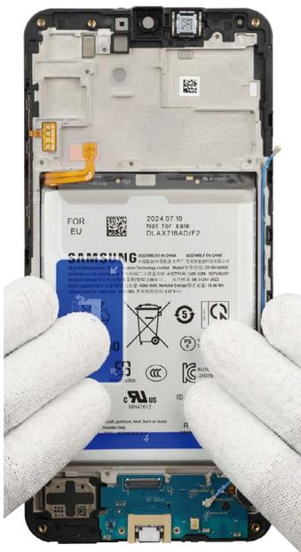
5 Inserte la almohadilla de presión de la batería en la parte frontal de la bandeja de presión inferior. Presione todos los bordes de la almohadilla con los dedos y asegúrese de que esté bien colocada.
