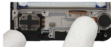
5 Utilice las pinzas para retirar con cuidado la cinta adhesiva del módulo del puerto de carga.
