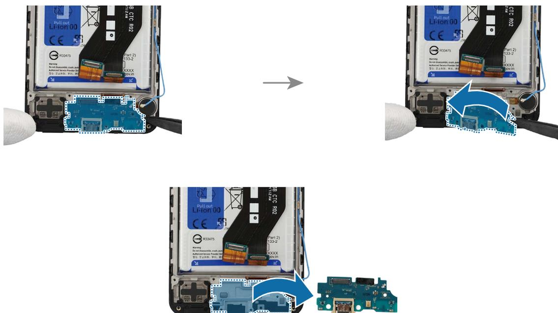
4 Utilice las pinzas o los dedos para separar con cuidado la goma del puerto de carga del módulo del puerto de carga.
