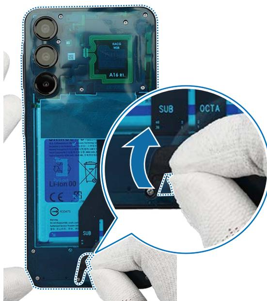
6 Monte la tapa posterior y presione los bordes. Compruebe si queda algún hueco entre la tapa posterior y el chasis metálico.
