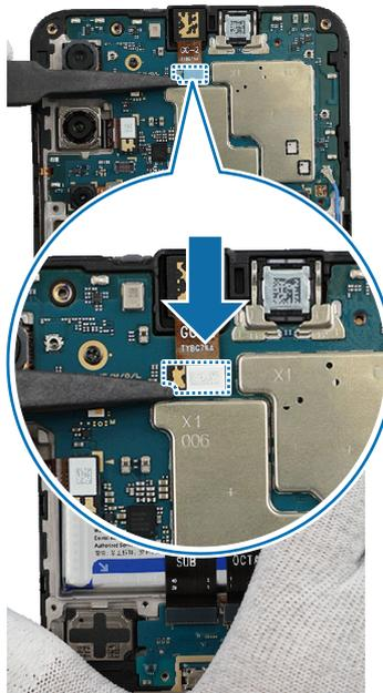
2 Conecte el conector de la batería a la placa principal.
