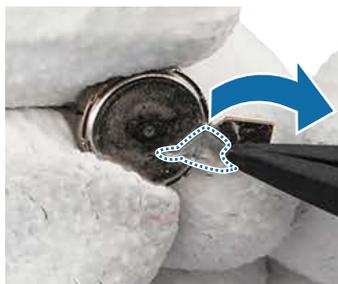
2 Retire la película transparente de la nueva cinta adhesiva del motor de vibración y coloque la cinta en la parte inferior del motor. Presione suavemente la cinta con los dedos de forma que quede bien fijada.
