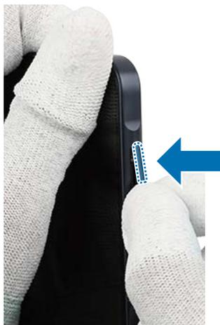
2 Presione el botón Volumen con cuidado y de manera uniforme para que pueda ensamblarse completamente. Pulse el botón Volumen para asegurarse de que haga clic. Debe tener el mismo sonido y el mismo tacto que antes del desmontaje.
