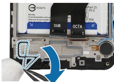
2 Utilice las pinzas para retirar la película protectora de la cinta adhesiva del nuevo altavoz inferior. Alinee la silueta de la cinta con la ubicación del altavoz inferior y fíjela con precisión. Presione hacia abajo suavemente la cinta con las pinzas de forma que la cinta quede bien fijada.
