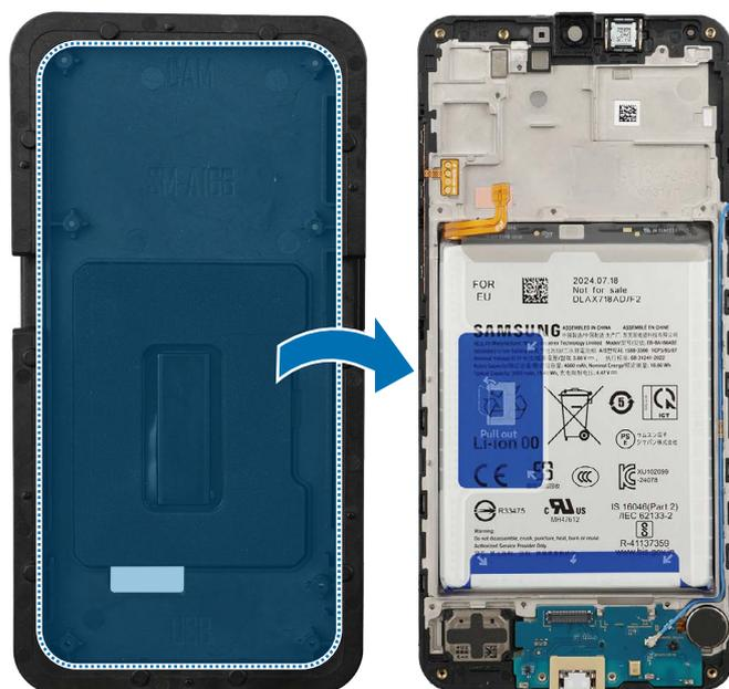
11 Alinee el módulo de la placa principal con el chasis del dispositivo. Después de acoplar la parte superior de la placa principal en diagonal sobre el módulo de pantalla, monte la parte inferior.
