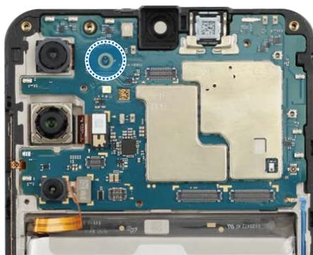
13 Utilice los dedos o las pinzas para colocar la cámara frontal en el orificio de la cámara de forma que la lente esté orientada hacia delante, e inserte con suavidad la cámara frontal. Conecte con cuidado el conector de la cámara en la placa principal.
