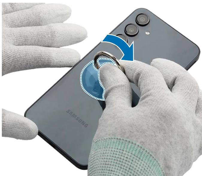
3 Mientras tira hacia arriba de la ventosa con fuerza continua para crear una separación entre la tapa posterior y el módulo de pantalla, coloque la púa de apertura en la separación existente entre la tapa posterior y el módulo de pantalla, y deslice la púa de apertura hacia atrás y hacia adelante para recorrer y separar el adhesivo. Repita esta operación en todos los lados de la tapa posterior y separe el adhesivo. Levante la tapa posterior lentamente y retírela con cuidado del dispositivo.
