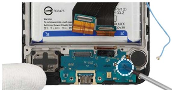
3 Utilice las pinzas para levantar la muesca de separación del módulo del puerto de carga, y retire este con cuidado.
