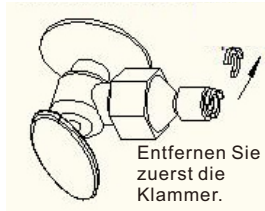
SCHRITT 2: Schrauben Sie den Schnellverbinder mit dem Gewinde auf den Wasserhahn und entfernen Sie die Klammer.
