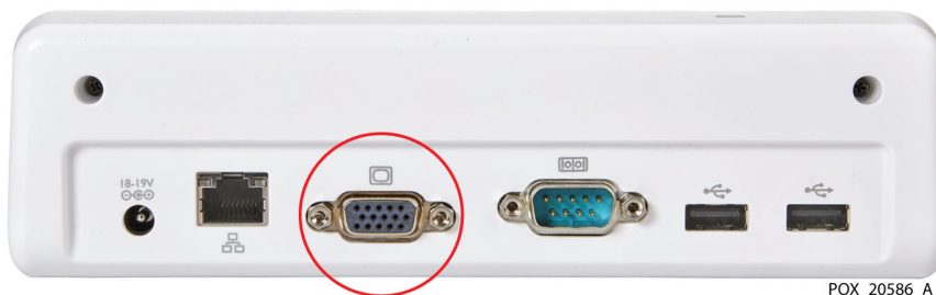
Рисунок 66. VGA порт на установочной станции
