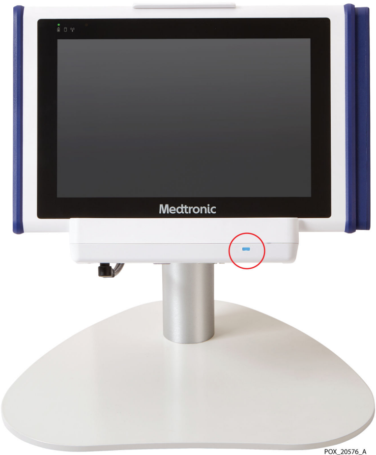
Рисунок 11. Индикатор питания установочной станции
