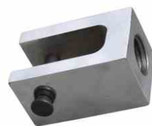
AJJ-15 名称: U型夹具 最大负荷: 5KN、1KN、20KN、50KN U口尺寸: 18mm、22mm、26mm 插销直径: 11.5mm、19.5mm
