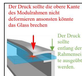
Abbildung 1a: Druck auf die Klemmenstellen
