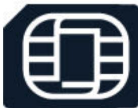
**Important :** cet appareil est conçu pour être utilisé avec une carte micro-SIM uniquement (voir photo). L'utilisation de cartes SIM incompatibles peut endommager la carte ou l'appareil et corrompre des données stockées sur la carte. Consultez votre opérateur mobile pour l'utilisation d'une carte nano-UICC.
