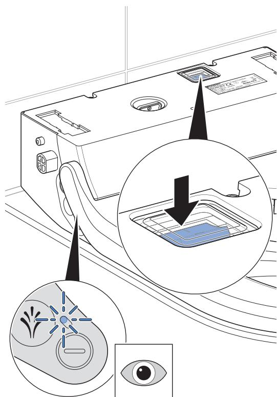
✓ LED indikator na bočnoj kontrolnoj tabli treperi/gasi se.
