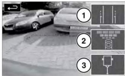
1. Коснитесь для включения/выключения направляющих линий системы помощи при парковке Park Assist (Park assist guidance).
