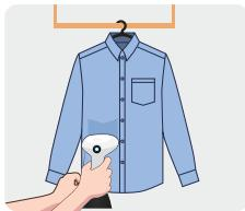
Encienda el vapor, presione suavemente el área arrugada con el panel de planchado y pláñchelo lentamente hacia arriba y hacia abajo. Alto El vapor a temperatura ambiente suavizará la tela arrugada y El panel de planchado alisará la ropa. Las áreas Con arrugas severas, se requiere una retención de vapor más prolongada. tiempo.
