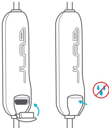
Antes de carregar, o JLab BT necessita de estar completamente seco. Se houver alguma exposição a humidade, os componentes internos podem ser danificados. Antes de carregar, o melhor é deixar secar ao ar livre.
