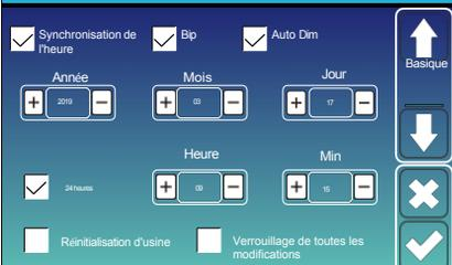
**Réinitialisation d'usine** : réinitialise tous les paramètres du variateur. **Verrouiller toutes les modifications** : activez ce menu pour définir les paramètres qui doivent être verrouillés et ne peuvent pas être configurés. Avant d'effectuer une réinitialisation d'usine et de verrouiller les systèmes, vous devez saisir un mot de passe pour activer le paramètre afin de conserver toutes les modifications.
