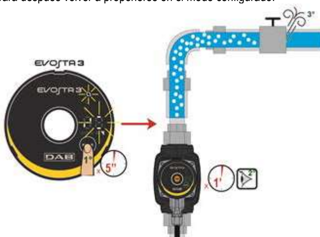
Figura 8: Purga automática de la bomba
