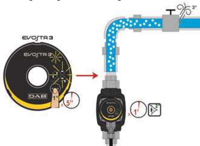
Afbeelding 8: Automatische ontluchting van de pomp
