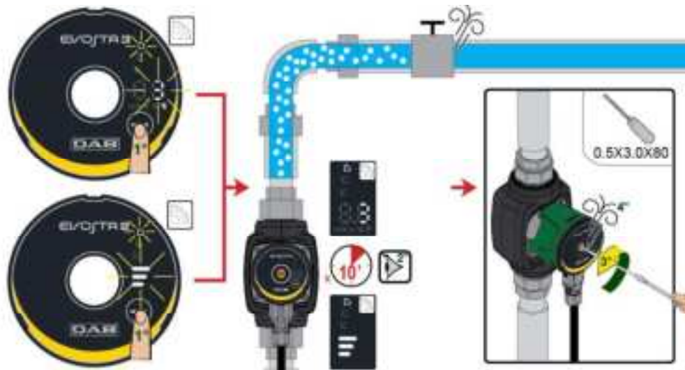
Afbeelding 7: Ontluchting van de pomp
