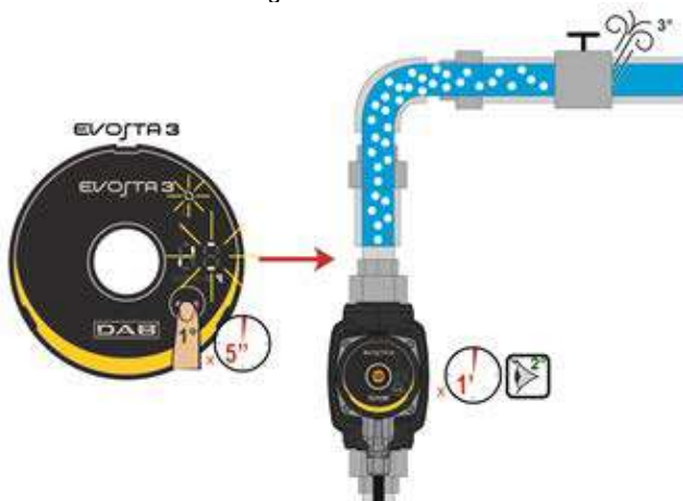
Image 8: Purge automatique de la pompe
