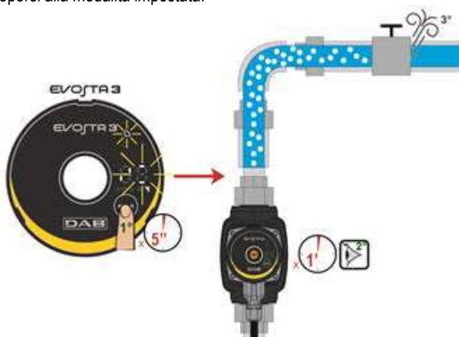
Figura 8: Sfiato automatico della pompa
