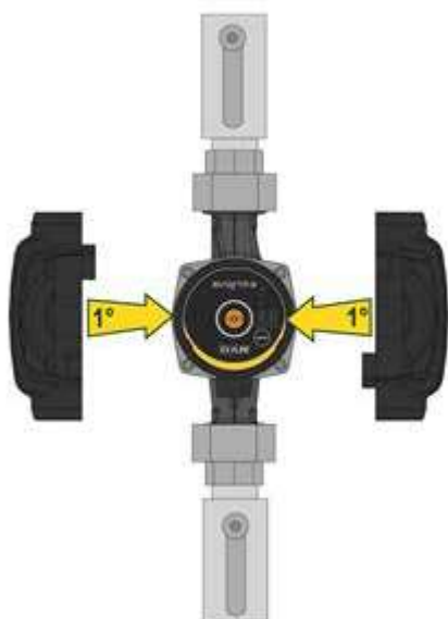
Image 6: Isolation du corps de pompe
