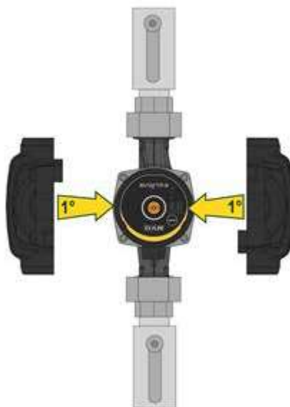
Abb 6: Isolierung des Pumpenkörpers
