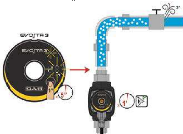
Image 8: Purge automatique de la pompe
