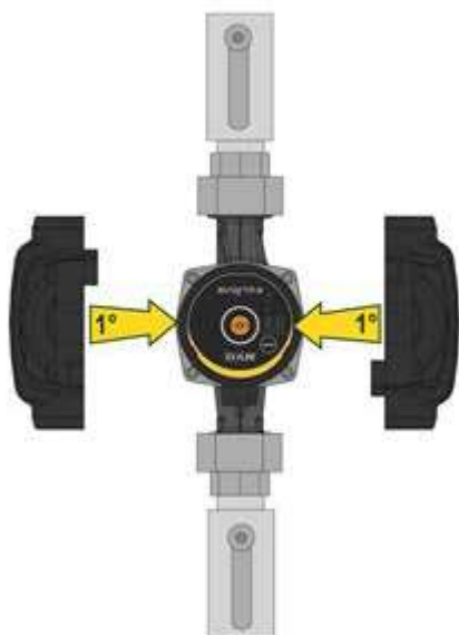
Afbeelding 6: Isolatie van het pomphuis
