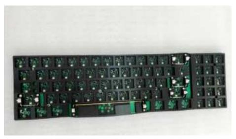
Place the mounting plate (FR-4/brass/aluminum) on top of the Poron plate foam. 將定位板(FR-4/黃銅/鋁)放置在 Poron 夾層泡綿上。
