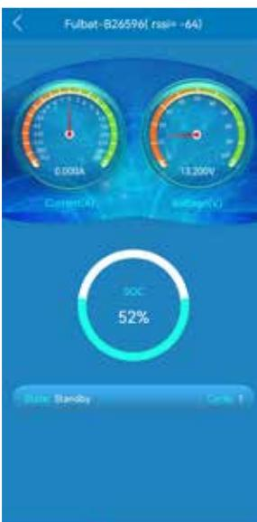
Ouvrez l'application sur le smartphone (à moins de 5 mètres de la batterie). Le numéro de série imprimé sur le côté du boîtier\* (Fulbat-B26602, Fulbat-B26586, etc.) s'affichera automatiquement sur cette page. Sélectionnez votre batterie avec le numéro de série, cliquez pour vous connecter à la batterie. Si plusieurs batteries sont connectées en série ou en parallèle, différents numéros de série apparaîtront sur la page.
