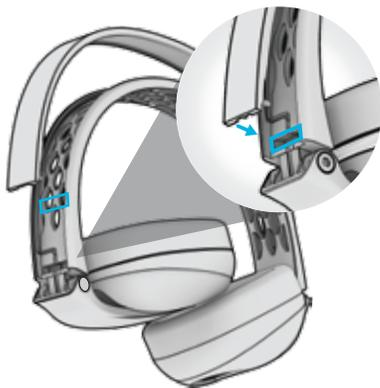
**2 RIMOZIONE:** Piegare in dentro i padiglioni mediante le apposite cerniere e individuare la fessura di smontaggio dell'archetto. Fare leva con il dito verso l'esterno per sbloccare l'archetto.
