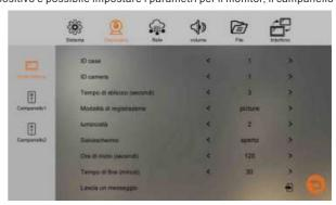
Quando nel sistema videocitofonico sono presenti più monitor (un sistema supporta fino a 6 monitor, 1 master e 5 slave), è possibile definirlo modificando l'ID camera, L'ID 1 è il monitor principale, gli ID 2-6 sono i monitor slave.
