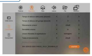
In un sistema supporta il collegamento di 2 campanelli esterni, campanello 1 e campanello 2. Se il campanello non è collegato al monitor non è possibile modificare I parametri.
