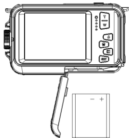
Installatie van de lithiumbatterij
