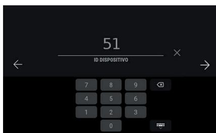
La schermata successiva consente l'inserimento dell'ID del dispositivo: il campo risulta pre-compilato con un valore di ID calcolato secondo l'algoritmo Due Fili, quindi, ad esempio, in caso di ID di gruppo 1, l'ID proposto per il dispositivo sarà 51 (oppure 52, 53) L'utente può confermare quanto proposto, o modificarne il valore e poi confermare.
