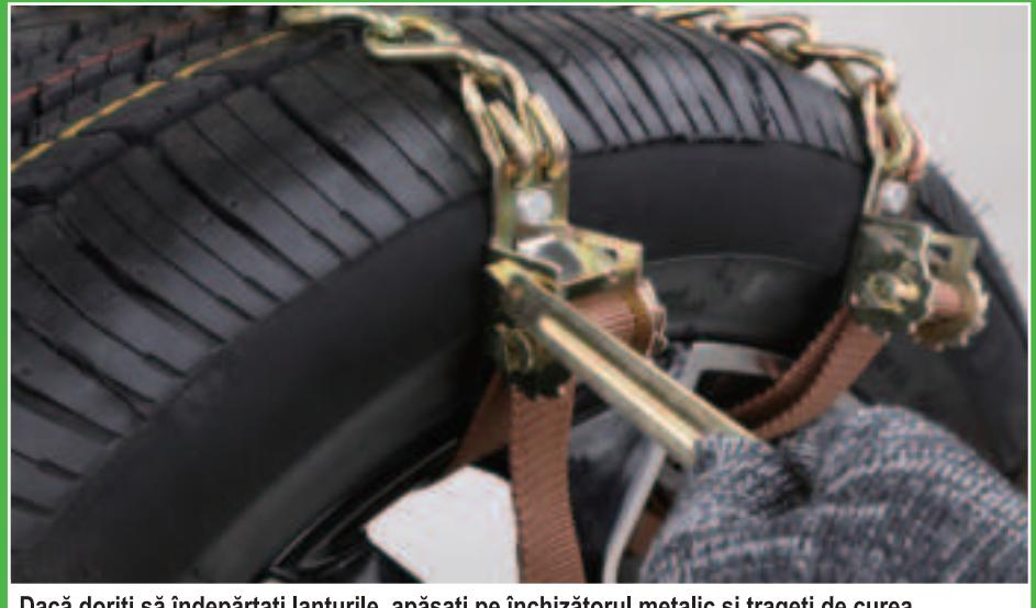
Dacă dorîti să îndepărtați lanțurile, apăsați pe închizătorul metalic și trageți de curea.
