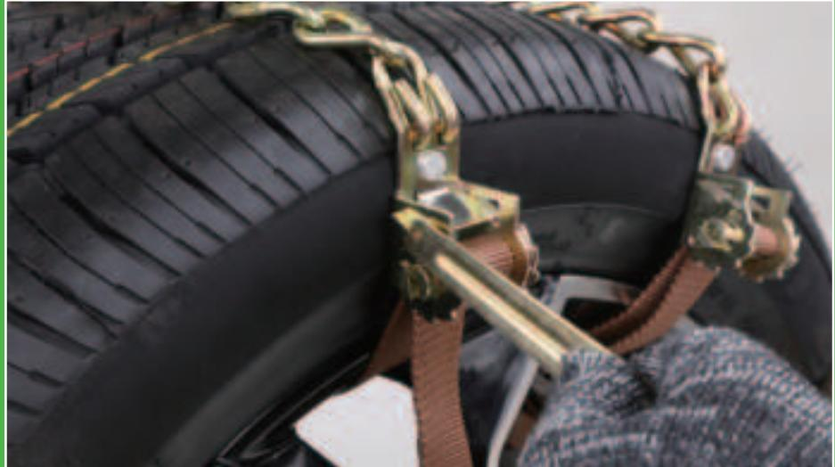
Αν θέλετε να αφαιρέσετε τις αλυσίδες, πιέστε το μεταλλικό κούμπωμα και τραβήξτε τη δέστρα.
