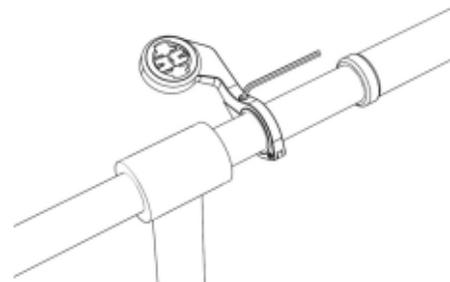
3. マウントをラバーパッド上のハンドルバーに取り付け、ネジを締め付けます。
